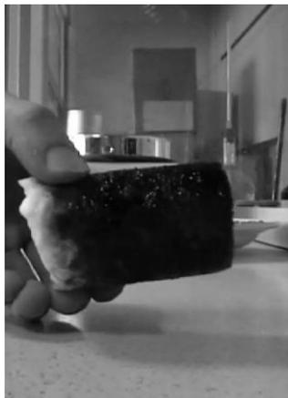
равной 2 °С, а затем, после снижения температуры в реакторе до -10°С при давлении 4 атмосферы. Фотография на рисунке иллюстрирует этот эффект: хорошо видна белая «шапка» выделившегося из эмульсии газогидрата. После отделения газогидрата определялось объемное содержание оставшейся воды в нефти, которое составляло менее 5% (при начальном содержанием воды — 75%). Механизм обнаруженного нами явления изучается.
